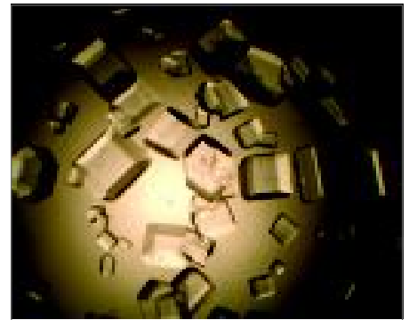
Рис. 2. Совершенный призматический габитус кристаллов утфеля I кристаллизации при уваривании на затравочной суспензии: d_{\text{ср}} = 0,75-0,85 \text{ мм}
